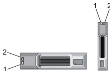
Figura 5. Indicadores de las unidades del Gabinete de expansión SCv300 y SCv320
