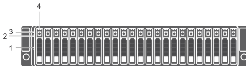
Figura 2. Funciones e indicadores del panel frontal del SCv320
